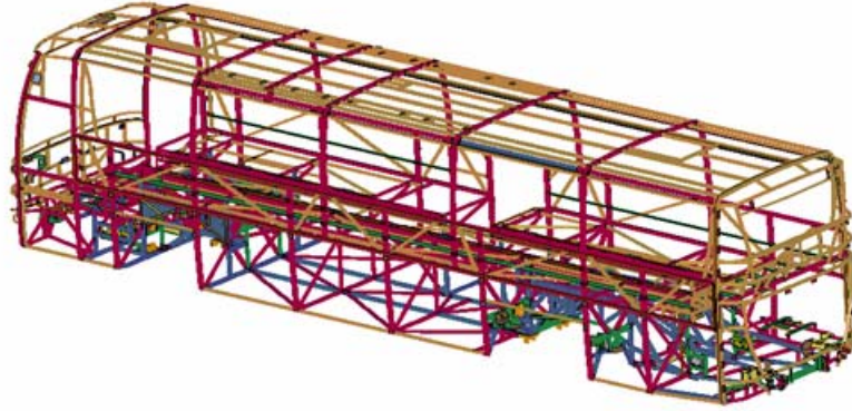
附图 A1 (a) 完全采用格栅底架式骨架结构的客车全承载式车身结构示意图
