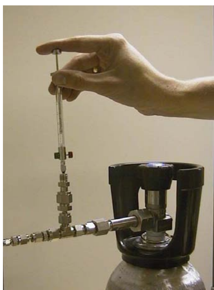
图 D.1 通过注射器引入液体的例子
