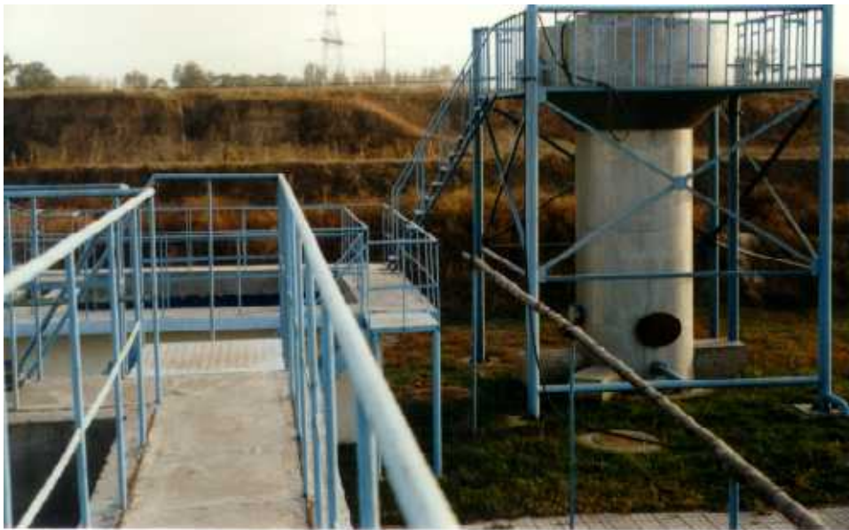
图 7 南顺流化床图 ( D \times H = 1.8 \times 6\text{m} , V = 20\text{m}^3 )
